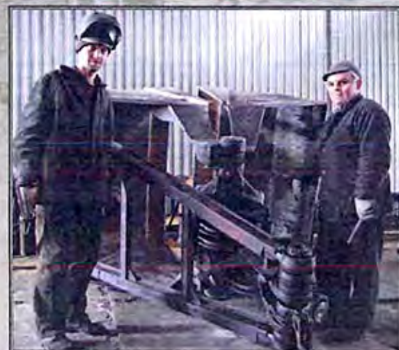
Сварщик В. Л. Кузьмичев и слесарь А. Н. Зажигин производят ремонт грейфера.
