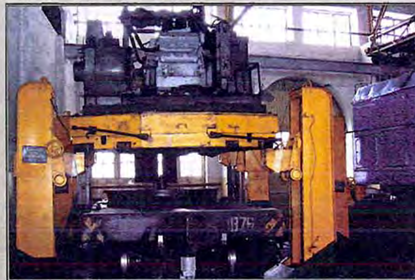
Разборка крана КДЭ-161 на ремонтной позиции
